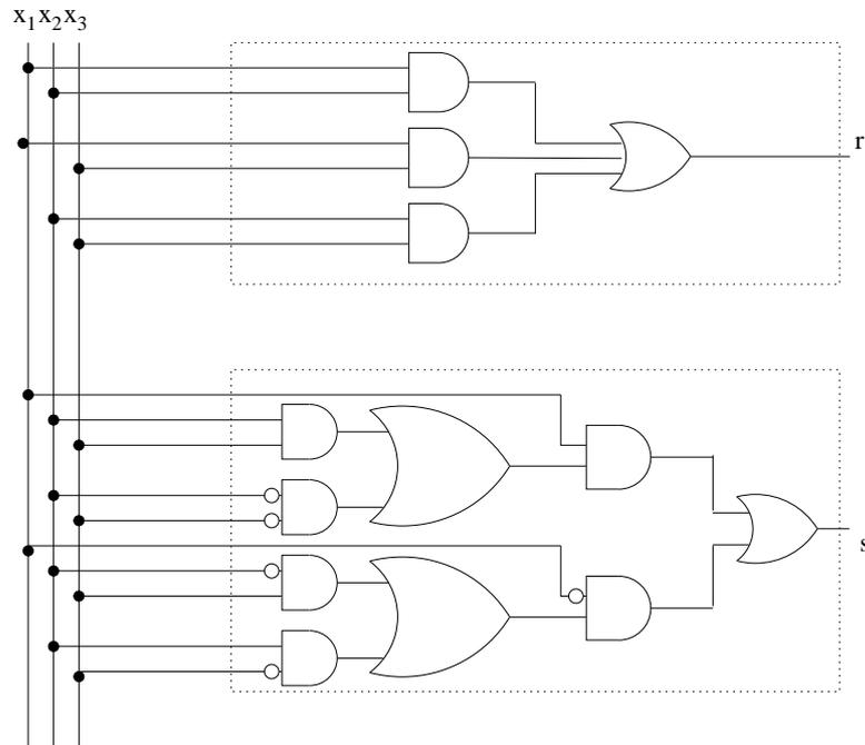
Figura 8: Il circuito del semisommatore a 3 bit.
